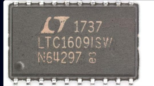
Chemische, mechanische und chemisch-thermische Verfahren. Untersuchung der Bauteilkennzeichnung und des Gehäuses auf Manipulationen.
