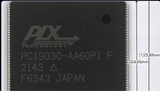
Mikroskopische Betrachtung sämtlicher Bauteiloberflächen, digitale Vermessung auf Maßhaltigkeit.
